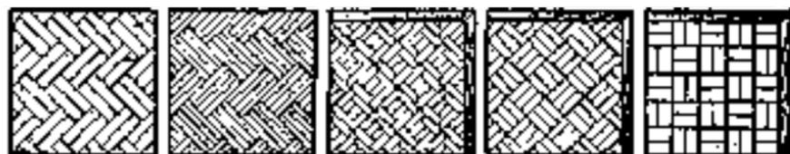
Рис. 217. Улучшенный рисунок шпунтового паркета.
