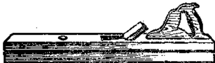
Рис. 152. Фуганок.
