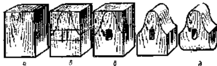
Рис. 20. Головка притирочного молотка:
